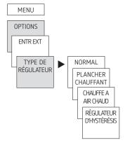
➤ Appuyer sur MENU, à l'aide de ► sélectionner le TYPE DE RÉGULATEUR et suivre les indications à l'écran.
